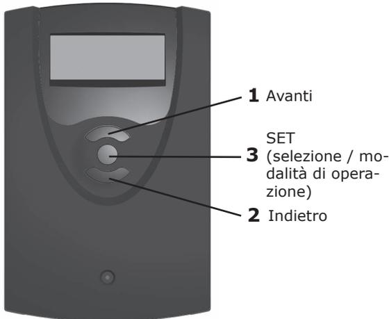
Attivare l'allacciamento elettrico. Il regolatore passa ad una fase d'inizializzazione. Dopo l'inizializzazione, il regolatore passa alla modalità di funzionamento automatico con i suoi settaggi di fabbrica. Lo schema del sistema preimpostato è SIST 1.
