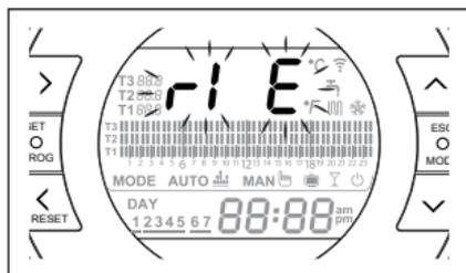
premere per 5 secondi il tasto ESC/MODE per avviare la procedura di riempimento semiautomatico (la scritta rIE diventa fissa). Al rilascio del tasto ESC/MODE la scritta rIE inizia a lampeggiare lentamente (2 sec) fino al termine della funzione.
