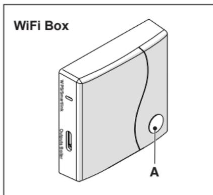
In presenza di allarme caldaia (disponibile con collegamento OTBus tra WiFi Box e caldaia o Ricevitore RF e caldaia o **BeSMART** e caldaia, se il protocollo OTBus lo prevede), premendo il tasto trasparente a bolla prismatica (A) è possibile resettare l'allarme (se presente l'allarme A99, il reset deve essere eseguito da caldaia).
