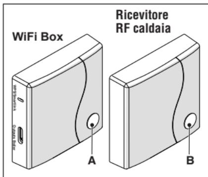
Spostarsi su Ricevitore RF caldaia e premere per 5 sec. il tasto a LED trasparente a bolla prismatica (B) del Ricevitore RF caldaia.
