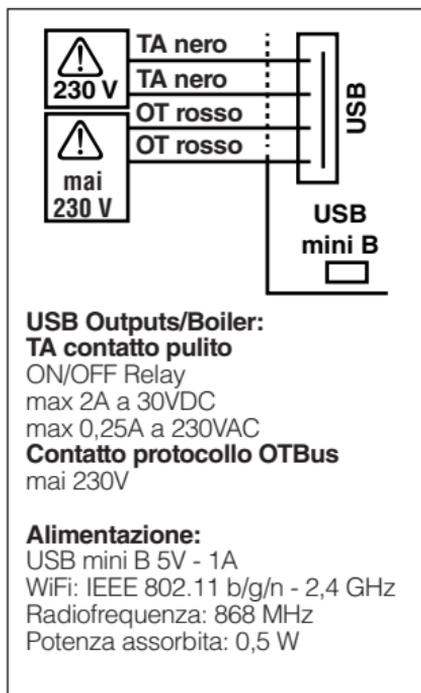
A corredo sono forniti 2 cavi USB, uno per alimentazione da alimentatore USB e l'altro per il collegamento del WiFi Box alla caldaia.
