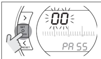
Premere il tasto UP ^ o DOWN v per inserire la password installatore (password = 18).
