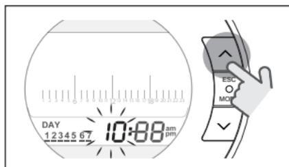
Premere il tasto SET/PROGRAM per memorizzare e tornare al menu programmazione, premere ESC/MODE per memorizzare ed uscire dal menu programmazione oppure attendere 30 secondi per memorizzare automaticamente il valore e tornare alla schermata HOME.
