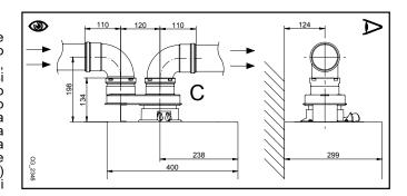
La curva a 90° permette di collegare la caldaia ai condotti di scarico e di aspirazione adattandolo alle diverse esigenze. Essa può essere utilizzata anche come curva supplementare in abbinamento al condotto o alla curva a 45°.
