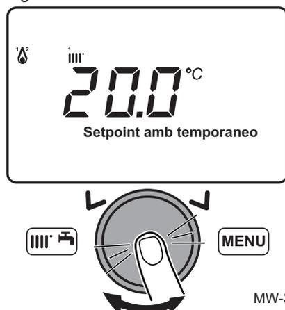
1. Dalla schermata principale del quadro di comando, ruotare il pulsante
