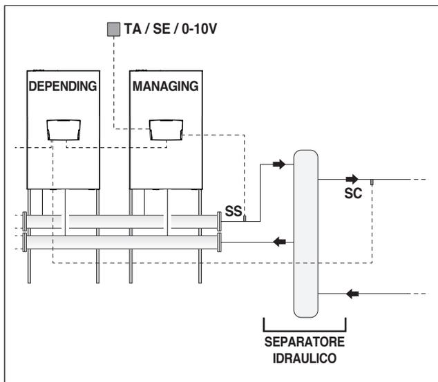
Per semplicità identifichiamo come secondario la circuitazione idraulica a valle del separatore.
