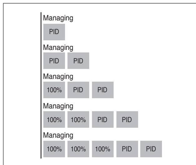
In pratica se il numero di moduli termici accesi è superiore a due, solo due moduli termici sono controllati tramite PID, mentre gli altri ricevono un segnale di portarsi alla massima potenza.
