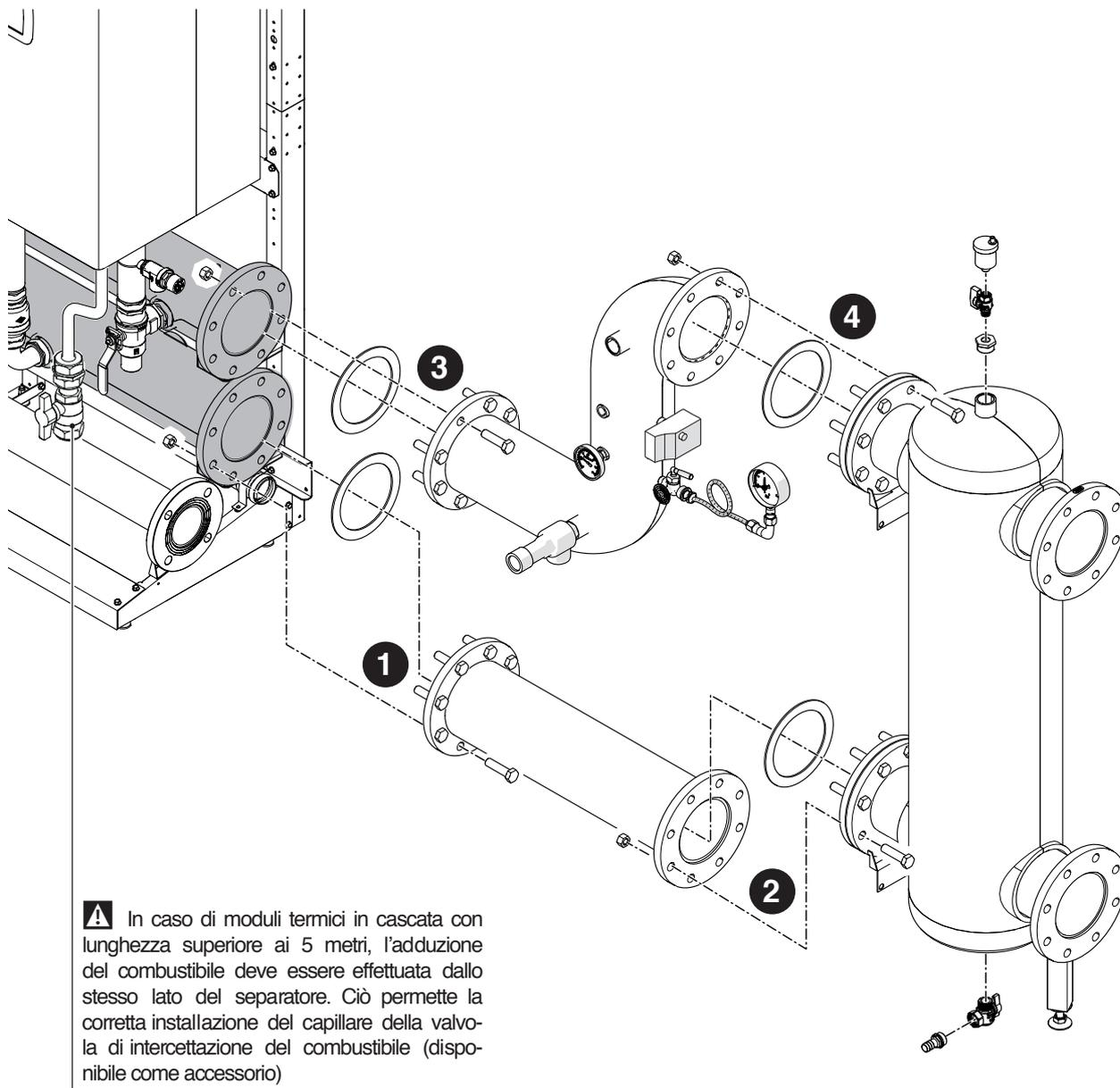
Una volta terminati tutti i collegamenti idraulici è possibile effettuare la prova di tenuta dell'impianto e montare gli isolamenti a completamento del sistema.
