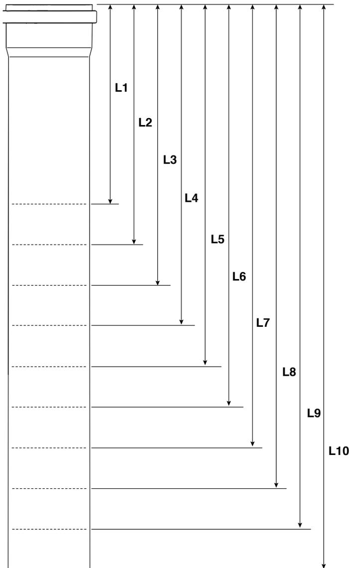
**⚠** SOLO PER MODELLI POWER MAX 65 P e POWER MAX 80 P aventi uscita fumi DN80 è richiesto un adattatore DN80/DN110 da installare sull'uscita del tubo fumi; ciò comporta che in questo caso le lunghezze di taglio devono essere ridotte di 60mm.
